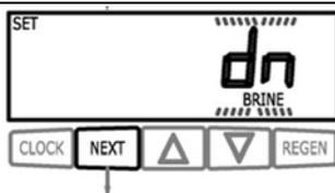
**Шаг 7CS.** Используя кнопки ▼ и ▲, установите прямоточную или противоточную регенерацию (**рекомендуется** Прямоточная регенерация - dn Brine). Нажмите кнопку «NEXT» для выхода из режима или «REGEN», чтобы вернуться к предыдущему шагу.
