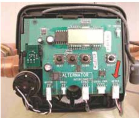
Кабель от общего счетчика воды нужно подключить к разъему METER в клапане «Alt B» (см. рис.).
